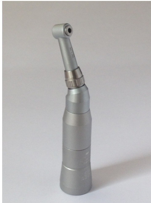
Abbildung 2. Mithilfe des abgewinkelten EVA-Winkelstücks wird die Geschwindigkeit reduziert und die rotierende Bewegung in eine oszillierende Bewegung umgewandelt.
