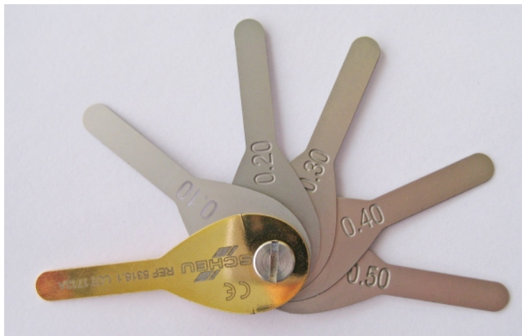
Abbildung 7. Das CA® Messlehren-Set besteht aus 5 Messlehren verschiedener Stärken (0,10 mm, 0,20 mm, 0,30 mm, 0,40 mm und 0,5 mm), die in die Interdentalräume eingebracht werden können, um den Schmelzabtrag zwischen den Zähnen vor und nach dem Strippen zu messen. Durch Kombination der Messlehren kann ein Abtrag zwischen 0,10 mm und 1,5 mm erfasst werden.
