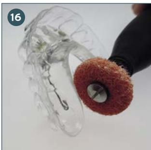
Wir empfehlen für die finale Randbearbeitung eine zugerichtete DIMO<sup>®</sup> PRO (siehe Abb.) und den SD-Hochglanzschwabbel in Verbindung mit der SD-Polierpaste A. Achten Sie auf eine niedrige Drehzahl (5.000 - 10.000 U/m)
