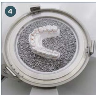
4 Modell ins Granulat einbetten, mit DURAN® 1,0 mm überziehen und anschließend grob mit der SD-Folienschere B ausschneiden.
